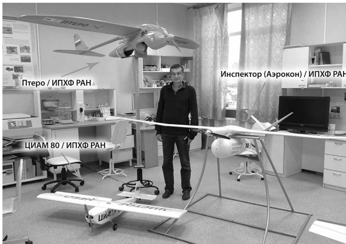
Руководитель лаборатории ионки твердого тела в ИПХФ РАН Ю.А. Добровольский с беспилотными летательными аппаратами на водородно-воздушных топливных элементах
