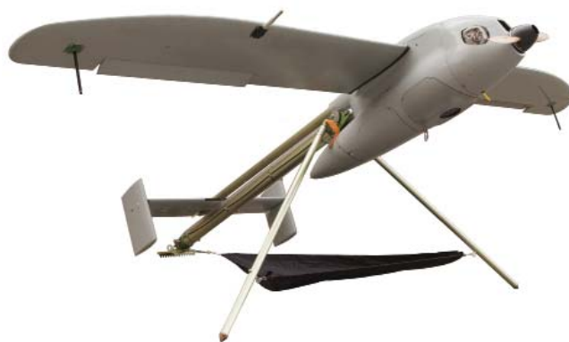
Рис. 5. БВС «Птеро-G1» на пневматической катапульте
