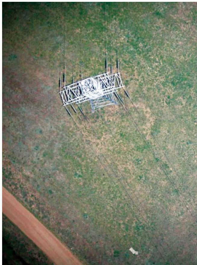
Рис. 7. Снимок трассы ВЛ, сделанный ночью при помощи специальной фотовспышки
