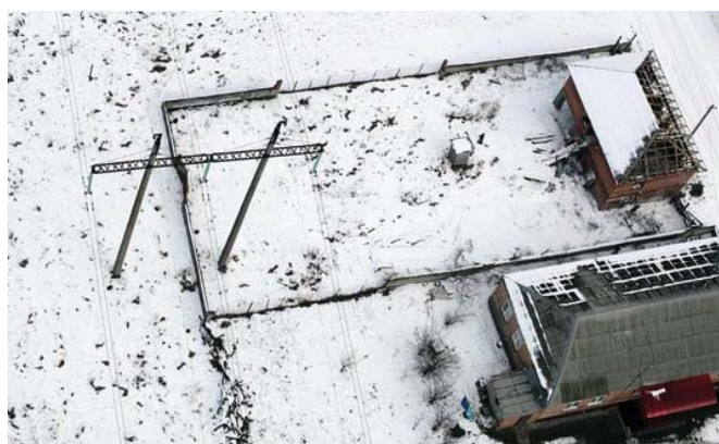
Рис. 2. Нарушение охранной зоны ВЛ (увеличенный фрагмент перспективного снимка, БАС «Птеро»)
